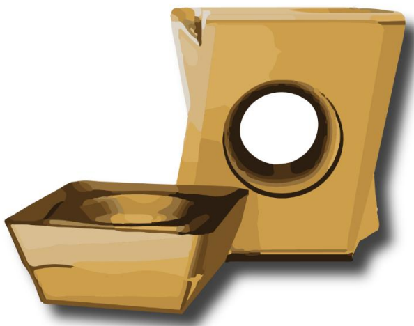
Figura 2. Insertos para mecanizado recubiertos con TiN, ampliamente utilizados en la industria metalmecánica por su alta dureza y resistencia al desgaste. Fuente: Elaboración propia
