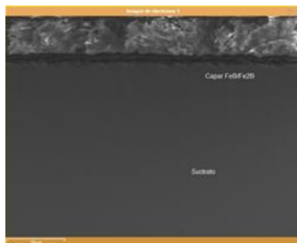
Figura 7. Imagen obtenida con el detector EDS, acero 4140. Microscopio Electrónico de Barrido, Laboratorio de Materiales de la DEPI, ITTLA. Fuente: Elaboración propia.
