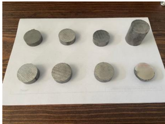
Figura 1. Corte de muestras de acero del tipo AISI 8620. Fuente: Elaboración propia.
