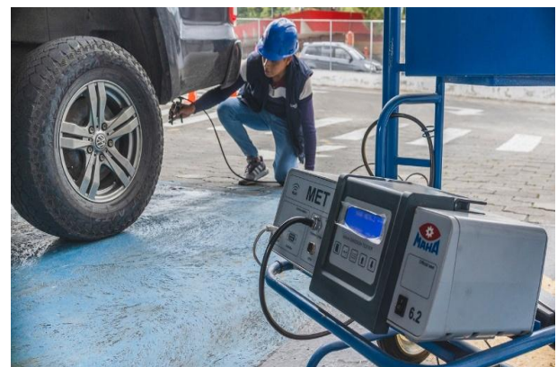
Figura 10. Equipo utilizado para medir la opacidad del humo en vehículos diésel. Fuente: Elaboración propia.
