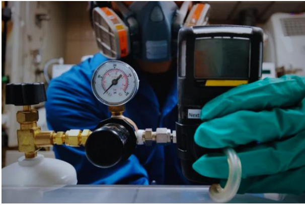
Figura 13. Procedimiento de calibración utilizando gases patrón con concentraciones conocidas. Fuente: Elaboración propia.
