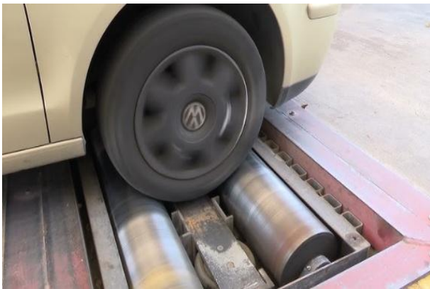
Figura 4. Banco de rodillos utilizado para simular condiciones de conducción en pruebas dinámicas. Fuente: Elaboración propia.
