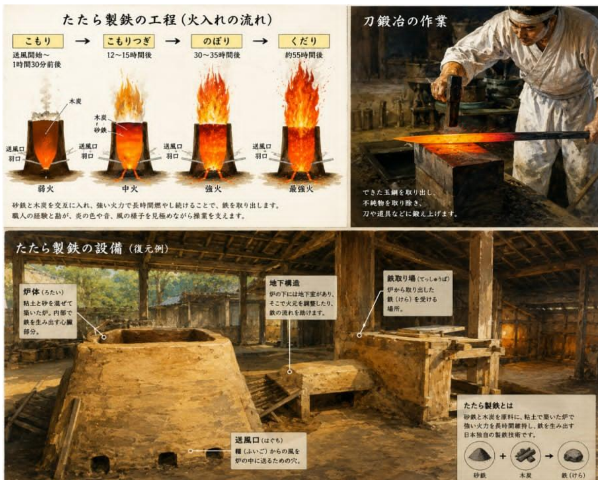
Figura 3. Producción tradicional de tamahagane en horno tataru.
