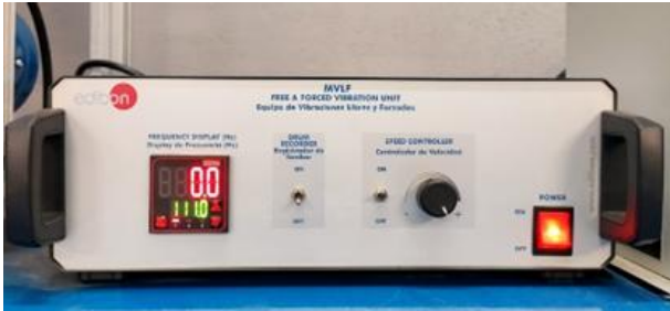
Figura 3. Unidad de control de velocidad. Fuente: Elaboración propia.
