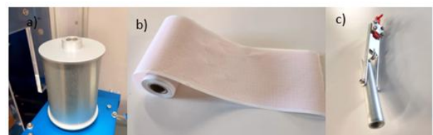
Figura 6. Sistema de registro gráfico: a) tambor registrador, b) papel registrador y c) bolígrafo. Fuente: Elaboración propia.
