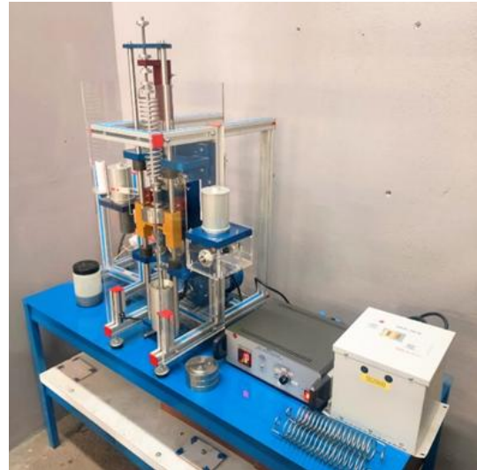
Figura 1. Sistema EDIBON MVLF para el estudio de vibraciones libres, forzadas y amortiguadas. Fuente: Elaboración propia.
