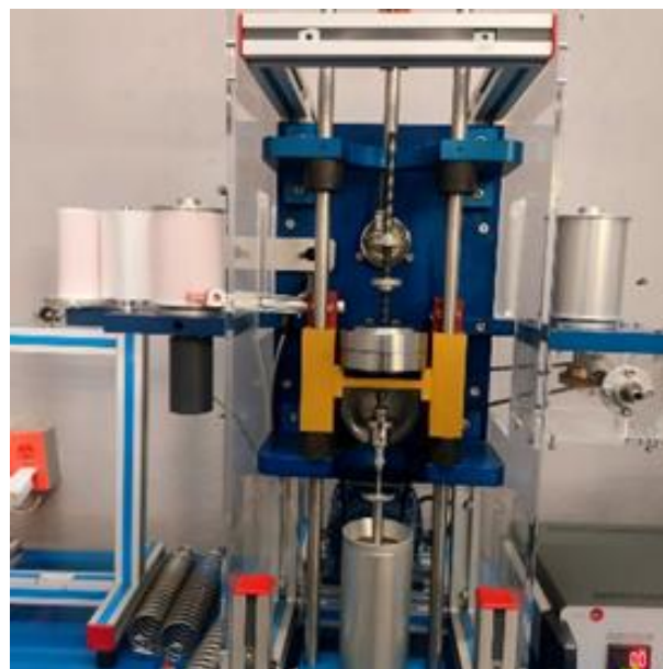
Figura 12. Sistema de vibración con amortiguador sin muelle o resorte. Fuente: Elaboración propia.
