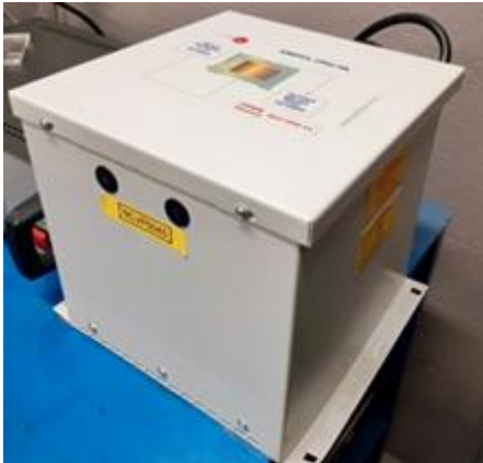
Figura 7. Transformador auxiliar y de protección de 4 kVA. Fuente: Elaboración propia.
