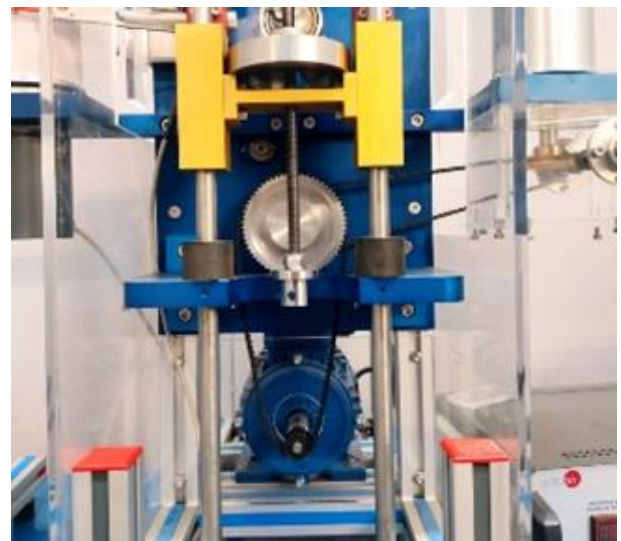
Figura 8. Sistema de vibración de un grado de libertad sin amortiguador. Fuente: Elaboración propia.
