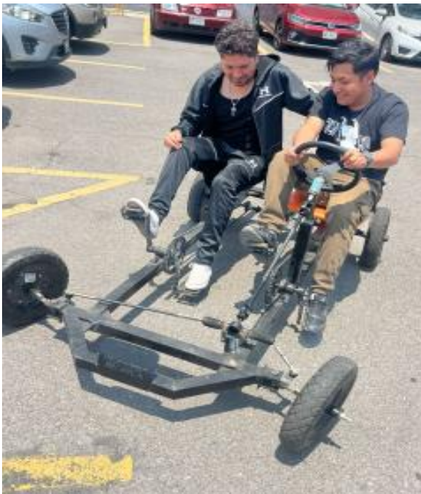
Figura 11. Prueba experimental de operación y capacidad de carga del triciclo recreativo con dos ocupantes. Fuente: Elaboración propia.
