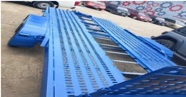
Figura 7. Ensamble final del piso con pintura. Fuente: Elaboración propia.
