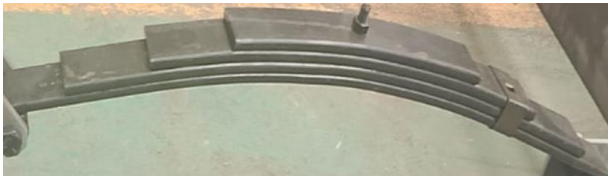
Figura 9. Conjunto de muelles empleadas para el remolque. Fuente: Elaboración propia.
