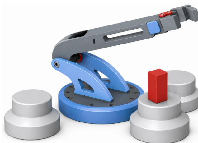
Figura 1. Representación tridimensional de un manipulador robótico de dos grados de libertad (2-GDL) con diseño tipo CAD, donde se ilustran los eslabones, las articulaciones rotacionales y el efector final, así como un entorno de trabajo con estaciones y una pieza a manipular, destacando mediante colores la estructura mecánica y los elementos funcionales del sistema. Fuente: Elaboración propia.
