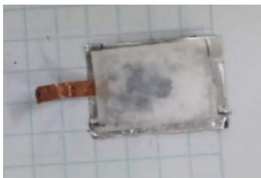
Figura 6. Colocación del separador impregnado con electrolito entre los electrodos.
