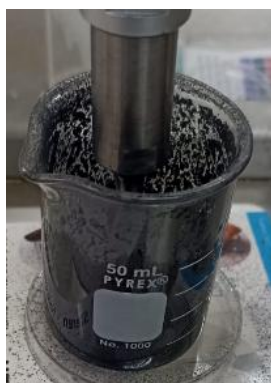
Figura 3. Dispersión de grafeno en acetona mediante baño ultrasónico.
