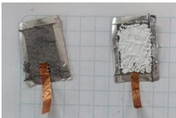
Figura 4. Depósito de \text{La}_2\text{O}_3\text{:Er} sobre un colector.
