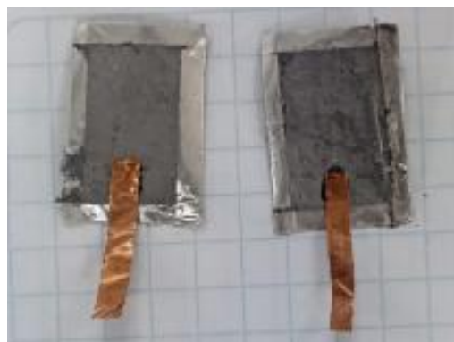
Figura 5. Delimitación del área activa con cinta adhesiva y depósito de la solución de grafeno por goteo.
