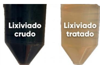
Figura 4. Muestras de lixiviado tratado por \text{O}_3 /US como pretratamiento, seguida de adsorción en biocarbón.
