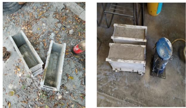
**Figura 5.** Engrase de moldes y vaciado de concreto.
