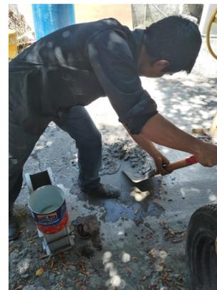
**Figura 4.** Mezcla del material.
