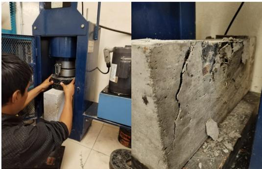
**Figura 7.** Prueba de compresión del bloque macizo.
