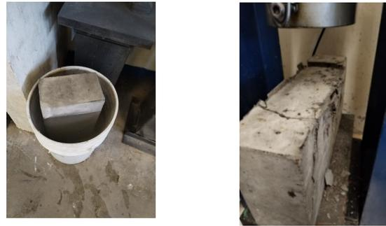
**Figura 9.** Curado del bloque macizo en agua durante 24 horas y prueba de compresión.
