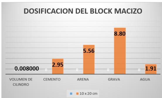
**Figura 2.** Gráfica de barras de la dosificación del bloque y cilindro.
