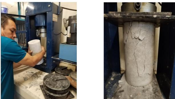
**Figura 8.** Prueba de compresión del cilindro.
