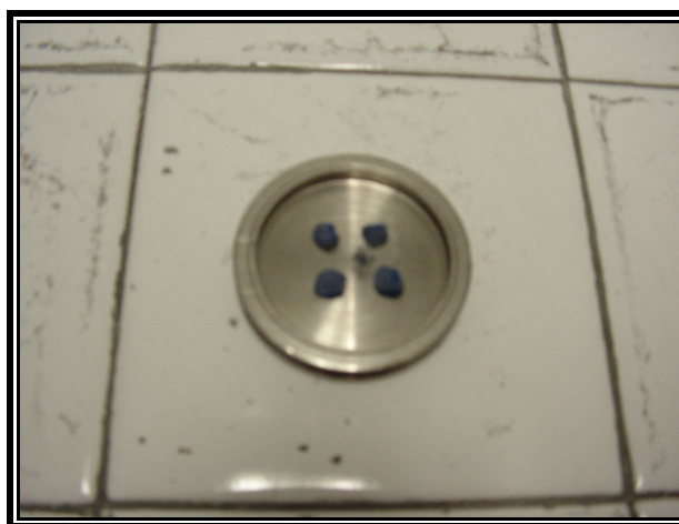
Figura 2.11 Portamuestras utilizado en DRX con soporte de vidrio amorfo y plastilina para el análisis de muestras en el orden de 6 mg.
