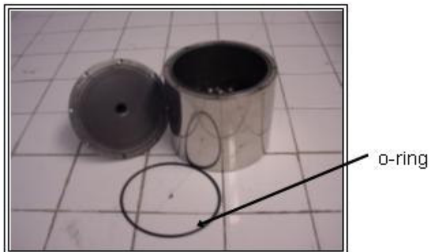
Figura 2.1 Sello de elastómero “o-ring” colocado en la boca del molino para asegurar un sellado hermético.
