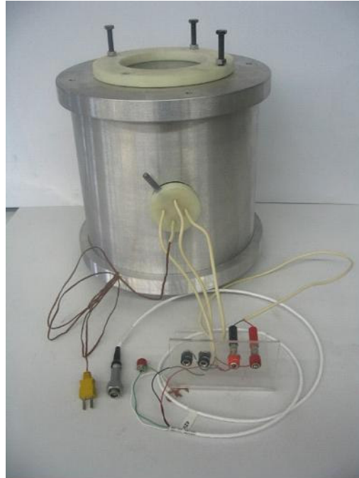
Figura 18. Celda protectora para medición de resistividad
