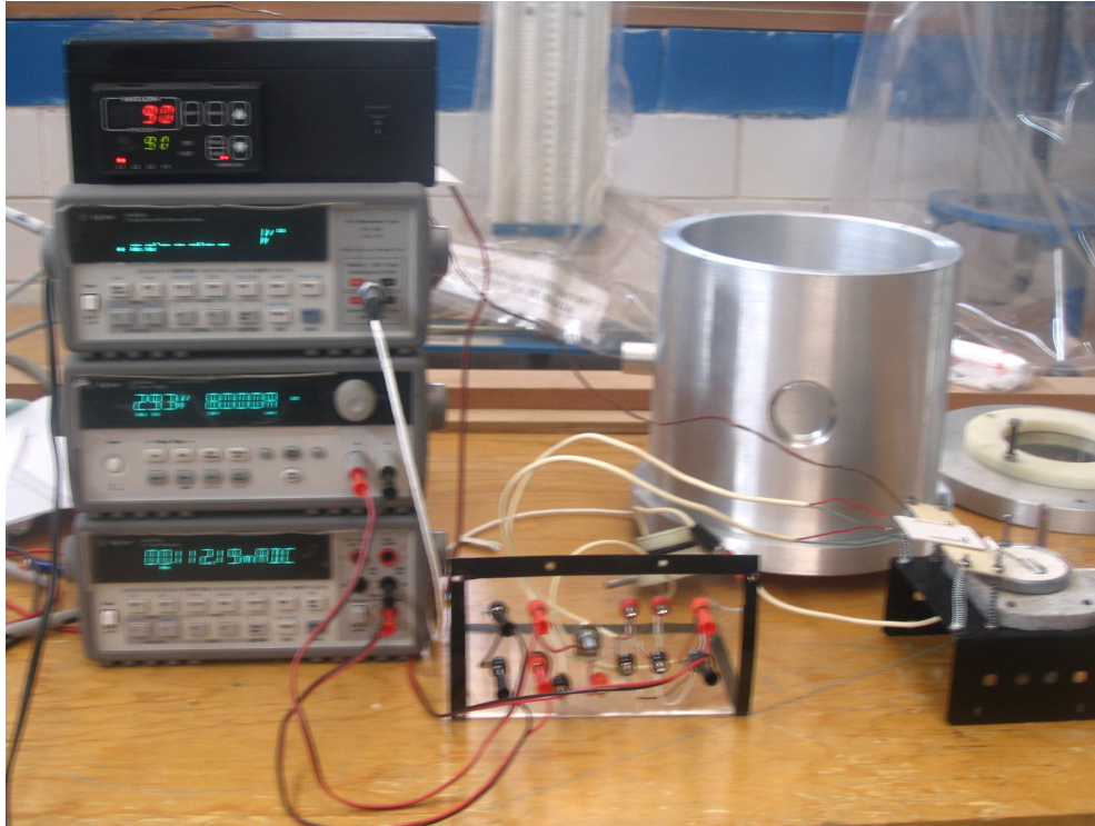
Figura 47. Arreglo utilizado para la medición de resistividad sin celda protectora
