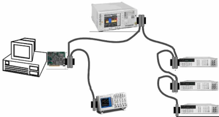
Figura 2. Ejemplo de configuración de un sistema GPIB
