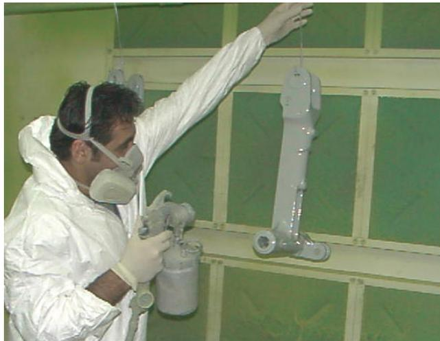
ILUSTRACIÓN 4.11 ROPA PROTECTORA PARA EL PROCESO DE PINTURA
