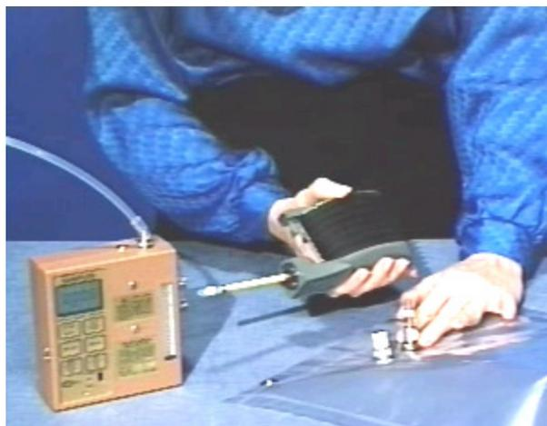
ILUSTRACION 3.3 ANÁLISIS CON TUBOS COLORIMÉTRICOS.
