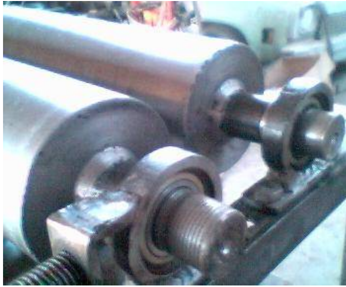
Figura 4.15 Acabados superficiales y laterales de los rodillos.
