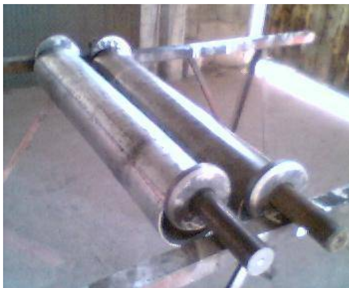
Figura 4.14 Armado de los rodillos.
