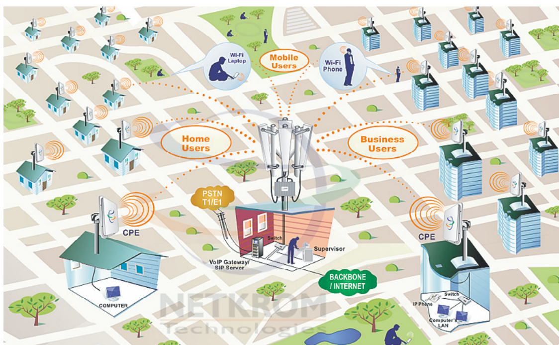
Figura 4.1 Diagrama generalizado que corresponde a la construcción del WISP [37].
