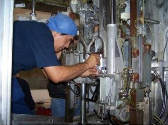
**Fig. 45** Mantenimiento para el Amortiguador del Sistema de Mordazas.
