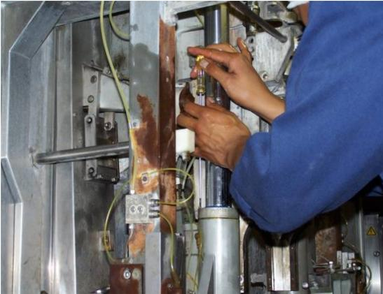
**Fig. 56 Ajuste del Amortiguador del Sistema de Mordazas.**
