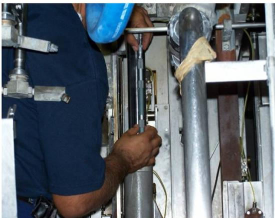
**Fig. 54 Calibración del Amortiguador del Sistema de Mordazas.**
