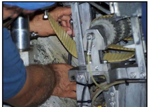
**Fig. 53 Ajuste de Banda de Plegadora Final.**
