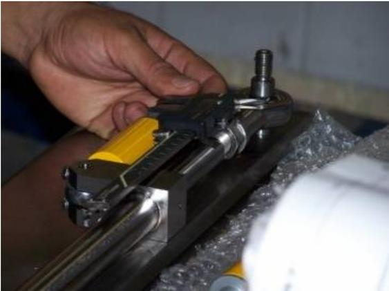
**Fig. 47** Calibración por medio del Vernier del Sistema de Mordazas.
