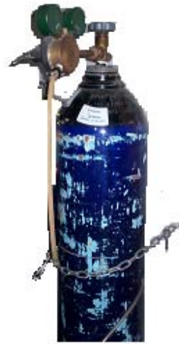
Figura 2.1 Tanque de Hidrógeno-Argón.
