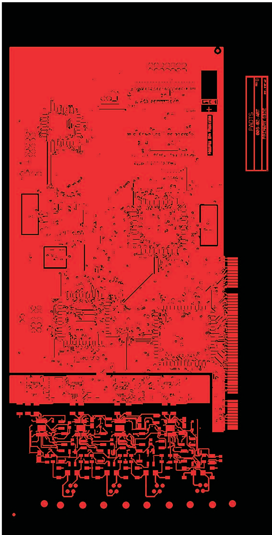
Figura 3.21: Capa de Señal Superior.
