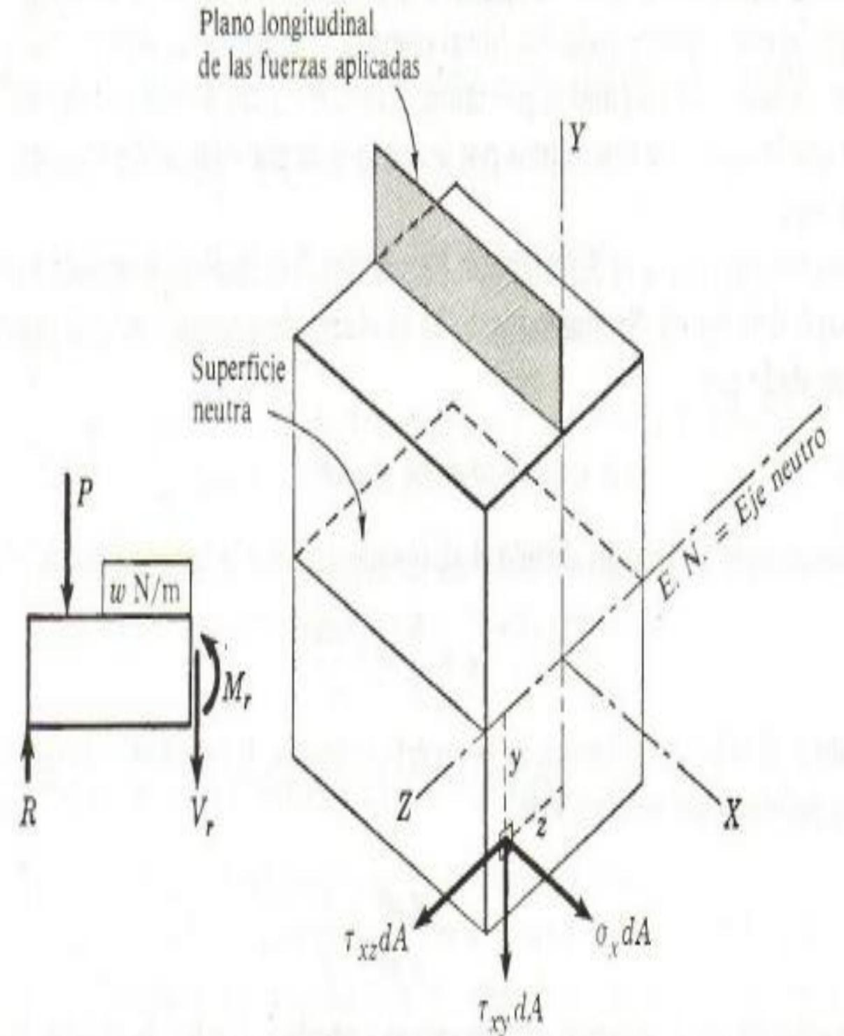
Figura 5-2. Fuerzas que actúan sobre un elemento de área de la sección recta.
