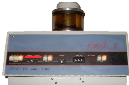
Figura 6 Ionizador de muestras para observar al MEB
