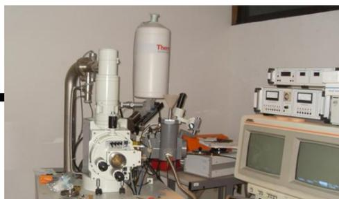
Figura 7 Microscopio Electrónico de Barrido.Instructions Jeol-1991.JSM - 6300.Scanning microscope.TokioJapan (Equipo para análisis morfológico de bacterias).
