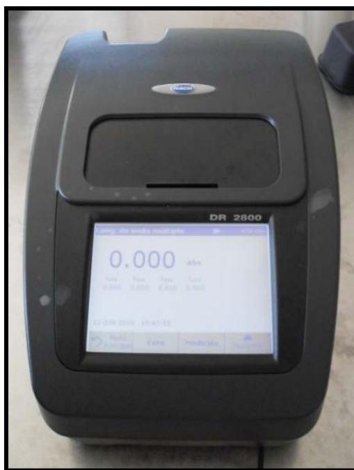
Foto 3.7 Espectrofotómetro UV modelo HACH DR. 2800
