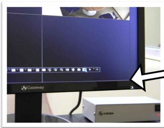
Presionar botón de encendido de monitor DVR para desactivarlo
