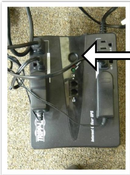
Apagar no brake (oprimir el botón de encendido durante 6 segundos hasta escuchar sonido alerta y observar led en color verde apagarse)
