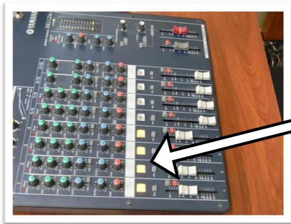
Verificar que los indicadores led se apaguen después de haber desactivado la consola por medio del switch
