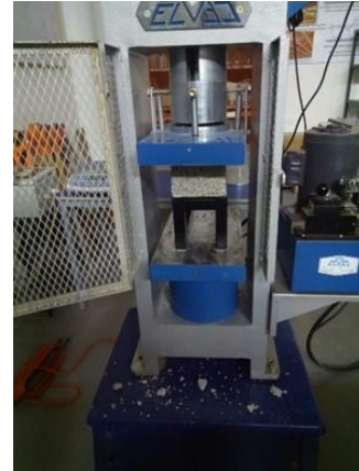
Figura 4: Prueba de resistencia a la compresión
