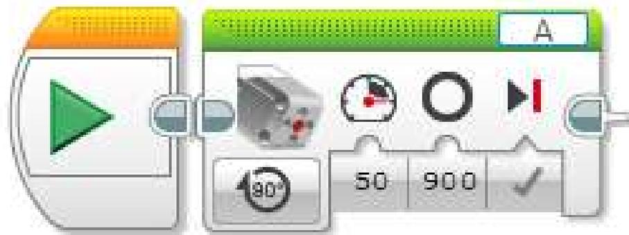
Este programa hará funcionar el motor en el puerto A al 50% de la potencia durante exactamente 900 grados (dos rotaciones y media) y luego lo detendrá.
