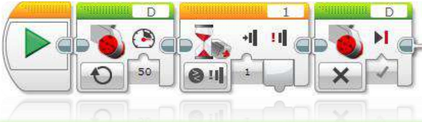
Utilice el modo encendido cuando desee que otros bloques de su programa controlen cuánto tiempo permanece encendido el motor. En este programa, el motor funcionará hasta que se presione un sensor táctil y luego se detiene.
