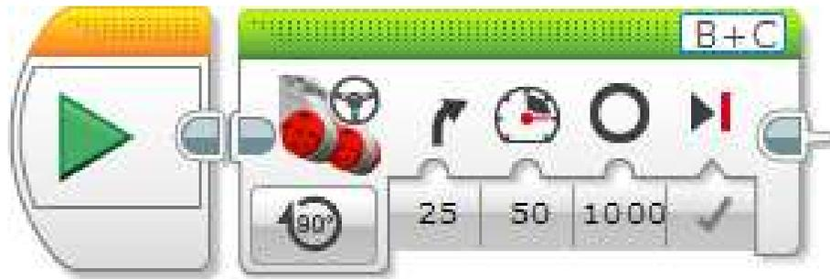
Este programa hará que un robot gire en un arco hacia la derecha, usando un valor de dirección de 25 y 50% de potencia. El giro continuará hasta que el motor izquierdo (el exterior y más rápido) haya girado exactamente 1000 grados, luego el robot se detendrá.
