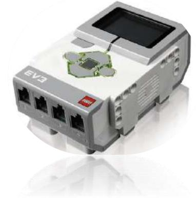
Es un juguete robot con un microcontrolador que permite su **programación** para su uso, que cuenta para su desplazamiento con ruedas y oruga. Además, de sensores de **distancia, color, giro y táctil, ultrasónico, infrarrojo, de temperatura.**
