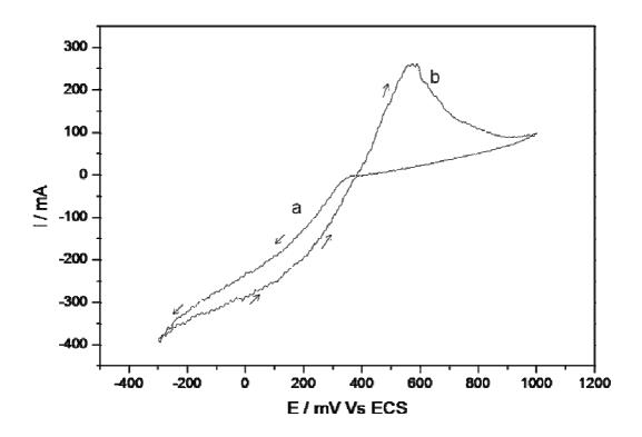
Figura 3. Voltamperograma del depósito de plata sobre un electrodo de A304 (Área de 64.3cm²) de la solución proveniente de los desechos sólidos de la industria radiográfica.
