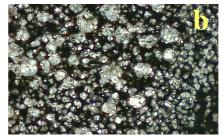
Figura 1 Productos de reducción de Ag sobre A304 a) imagen macroscópica y b) imagen amplificada.
