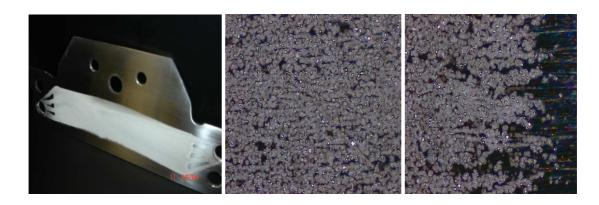
Figura 6. Recubrimiento obtenido sobre Acero inoxidable A304 después de realizar una cronopotenciométria a una corriente de -50mA durante 120 minutos.
