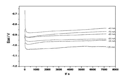
Figura 5. Cronoamperograma obtenido para la reducción del ion Ag<sup>+</sup> sobre un electrodo de A304 en una solución proveniente de los desechos sólidos de la industria radiográfica. Las diferentes corrientes impuestas al electrodo se ilustran en la figura.
