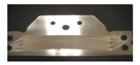
Figura 4. Depósito obtenido sobre el electrodo de Acero inoxidable después de hacer una macroelectrólisis a potencial controlado de 250 mV en una solución proveniente de los desechos radiográficos.
