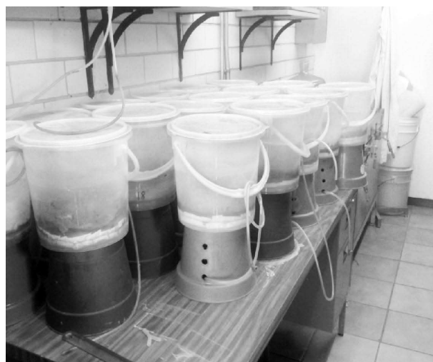
Figura 3. Sistema de 16 celdas de humedad utilizadas en la investigación
